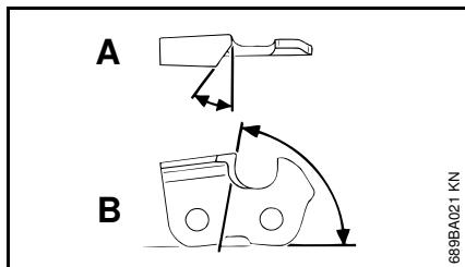
Углы у всех зубцов пильной цепи должны быть одинаковыми. При неодинаковых углах: грубый, неравномерный ход цепи, сильный износ – вплоть до разрыва пильной цепи.
