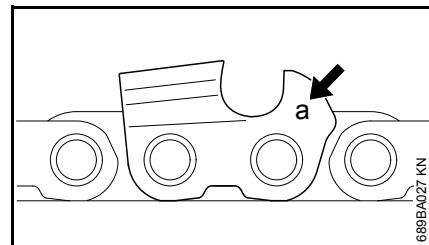
Обозначение (а) шага цепи выгравировано в области ограничителя глубины реза каждого режущего зубца.
