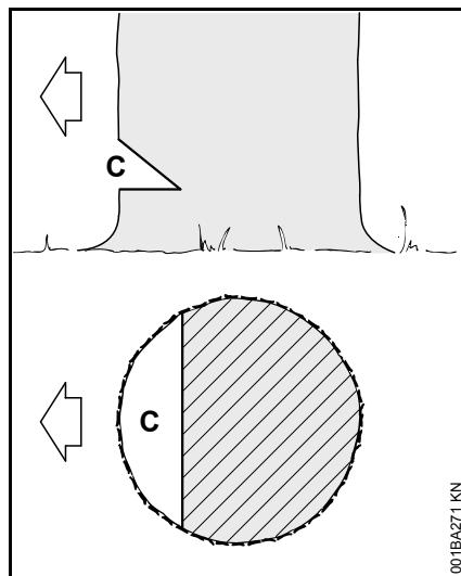
Подпил (С) определяет направление валки дерева.
