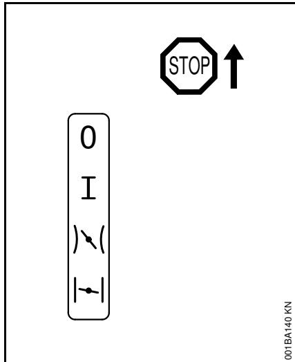
**STOP-0** – двигатель остановлен –
