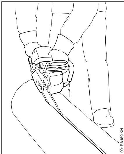
Техника пиления без использования зубчатого упора – опасность звягивания – направляющую шину устанавливать под как можно более плоским углом – работать особенно осторожно – повышенная **опасность обратного удара!**
