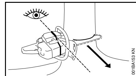
Данная бензопила предусмотрена с валовой планкой на кожухе о корпусе вентилятора. Использовать данную валовую планку.
